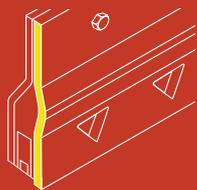
Die Küper Wave Technology optimiert den Schneefluss durch ihren gewellten Querschnitt. Sie leitet den Schnee ohne Widerstand über die Befestigungselemente ab.
