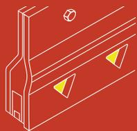
Das Küper Cooling System verhindert durch spezielle Öffnungen eine Erhitzung der Leiste.
